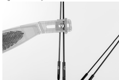
Fig. 60: Montaje de los reflectores laterales
