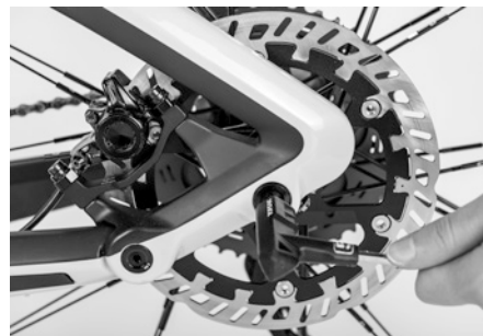
Fig. 54: Montaje del sistema de eje de la rueda trasera
