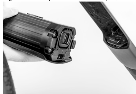
Fig. 32: Montaje de la batería de propulsión
