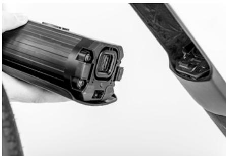
Pour terminer, bloquez la batterie de transmission dans le tube inférieur. Pour cela, in-
