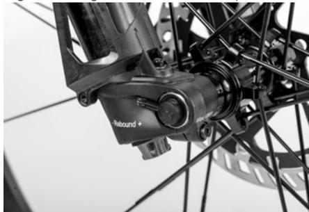
La roue avant du PORSCHE eBike Cross possède un vissage d'essieu sans outils. Dépliez le dispositif de serrage rapide sur l'axe vissable et poussez l'axe légèrement graissé à travers le moyeu jusqu'à ce que le filetage prenne dans l'extrémité de dégagement. Tournez l'axe à fond et établissez la précontrainte en rabattant le levier de serrage de 90° vers le haut.
