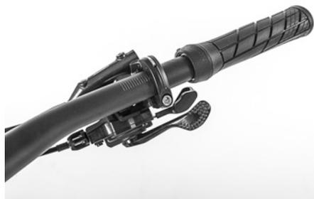
Fig. 24: Position du levier de vitesses (électronique)
