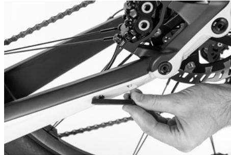
Fig. 57: Montage de la béquille
