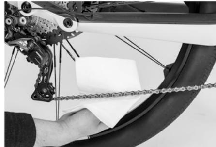
Fig. 21: Graisser la chaîne
