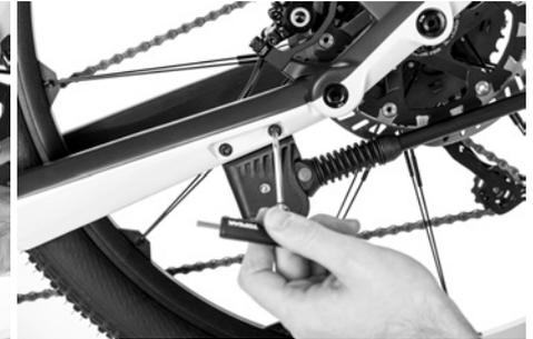
Pour monter maintenant la béquille, tenez la béquille sur le côté intérieur de la base de chaîne dans l'évidement prévu à ce effet.
