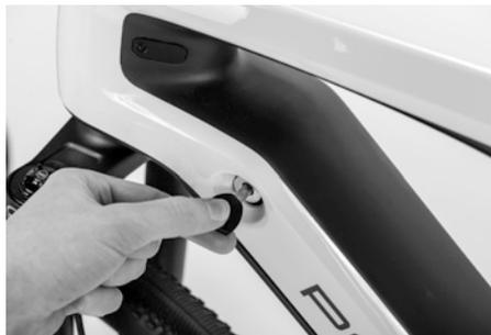
La batterie de transmission se détache de la fermeture de la batterie dans le tube inférieur. Une plaque de fermeture double maintient la batterie de transmission en position et l'empêche de tomber. Appuyez sur
