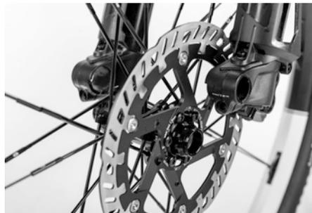
Sur les roues avant du PORSCHE eBike sont installés des axes vissables. Lors de la mise en place du moyeu de roue avant, veillez à ce que le moyeu soit bien en place dans les extrémités de dégagement et que le disque de frein soit bien centré dans l'étrier de frein.
