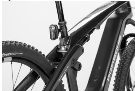
Les deux lumières sont livrées avec les vis adaptées. Elles sont serrées au couple de 4 Nm.
