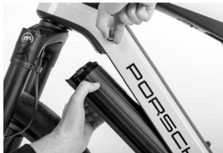
Fig. 31: Retrait de la batterie de transmission
