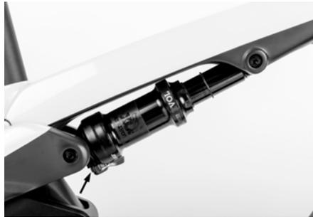
Pour le réglage correct, à la première étape, il faut tourner la molette de réglage rouge jusqu'à la butée dans le sens inverse des aiguilles d'une montre. Ensuite, la vis de réglage est tournée par petites étapes/clics dans le sens des aiguilles d'une montre jusqu'à ce que le réglage d'amortisseur correct soit configuré.
