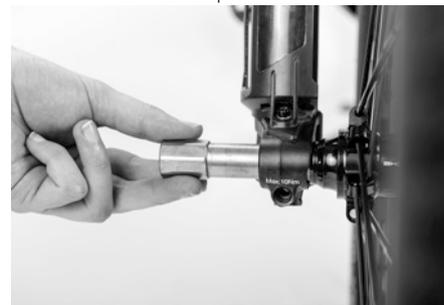
La roue avant du PORSCHE eBike Sport ne possède aucun vissage d'essieu sans outils. Une clé Torx (taille T25) est nécessaire. Avant le montage, assurez-vous que les filetages soient exempts de salissures et d'endommagements. Poussez l'axe d'enfichage légèrement graissé depuis la droite jusqu'en butée par les extrémités de dégagement et le moyeu.
