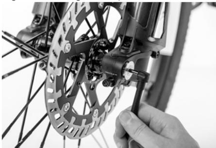
Fig. 51: Montage des vis de serrage
