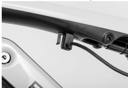
Afb. 27: Aansluitstekker in de juiste stand
