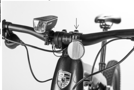
Afb. 62: Montage reflector voorkant
