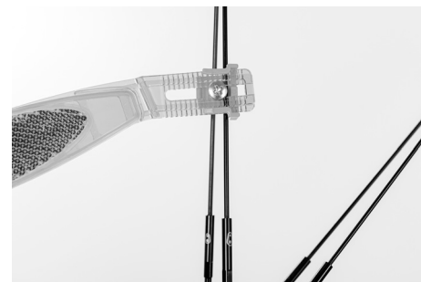
Fig. 60: Montaggio dei catarifrangenti laterali
