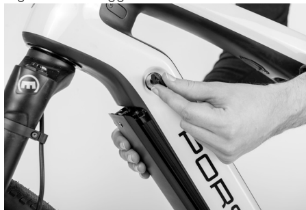
Fig. 33: Bloccaggio della batteria di trazione
