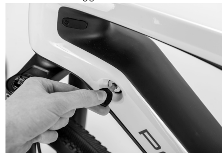
Fig. 29: Azionamento del meccanismo di sbloccaggio
