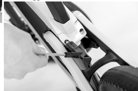
Fig. 10: Controllo delle viti di bloccaggio del reggisella
