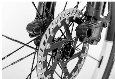
Fig. 48: Montaggio del collegamento a vite dell'asse / della ruota anteriore
