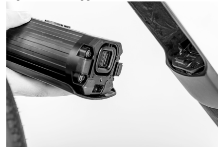
Fig. 32: Montaggio della batteria di trazione
