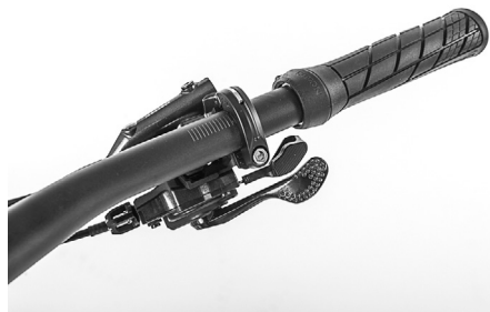
Fig. 23: Posizione della leva del cambio (meccanico)
