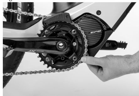
Fig. 22: Verificare le condizioni della catena
