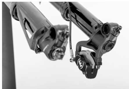
Fig. 64: Protezione per il trasporto del freno a disco
