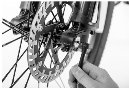
Fig. 50: Montaggio del cappuccio di sicurezza
