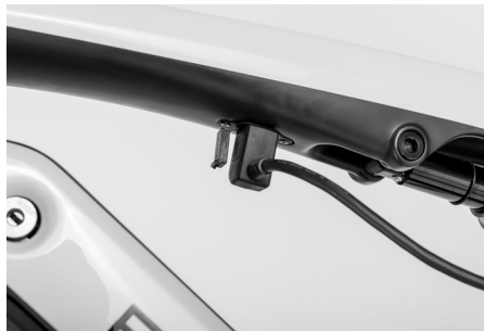
Fig. 27: Connettore di ricarica in posizione corretta
