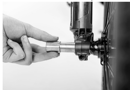
Fig. 49: Montaggio del sistema dell'asse della ruota anteriore Sport
