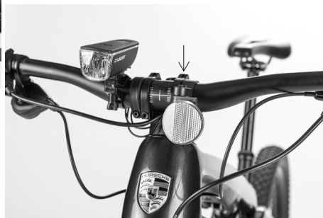
Fig. 62: Montaggio del catarifrangente anteriore
