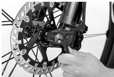
Fig. 8: Controllo del cappuccio di sicurezza della ruota anteriore
