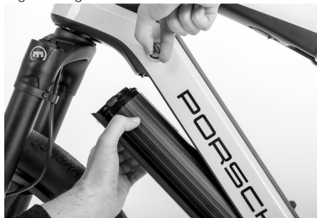
Fig. 31: Rimozione della batteria di trazione
