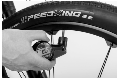
Fig. 12: Controllo della pressione di gonfiaggio degli pneumatici
