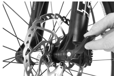
Fig. 53: Montaggio del sistema dell'asse della ruota anteriore Cross
