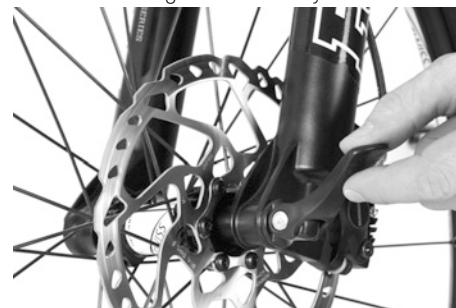
Afb. 53: Montage voorwielassysteem Cross
