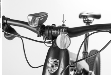
Afb. 62: Montage reflector voorkant
