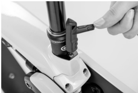
Afb. 11: Spieverbinding zadelpen controleren
