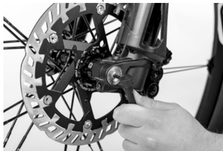
Afb. 8: Beschermkap voorwiel controleren
