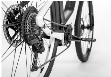
Afb. 18: Ketting op kettingblad/cassette
