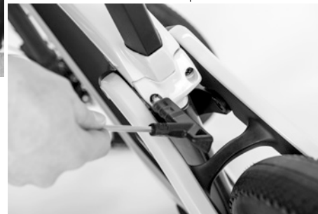
Afb. 10: Stelbouten zadelpen controleren
