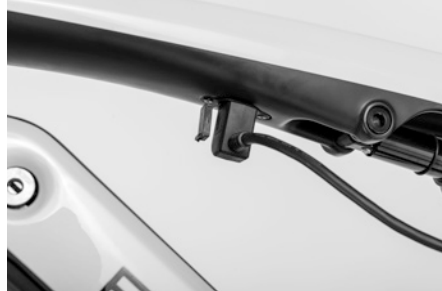
Afb. 27: Aansluitstekker in de juiste stand
