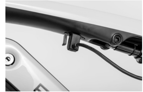
Abb. 7: Ladekabel Stecker / Antriebsbatterie
