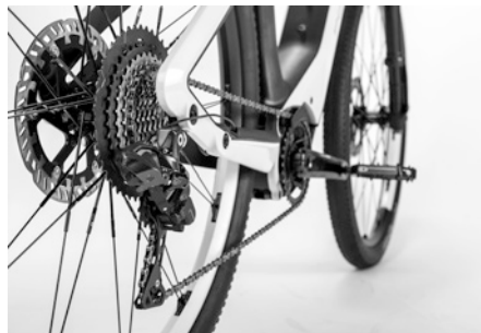
Abb. 18: Kette auf Kettenblatt / Kassette
