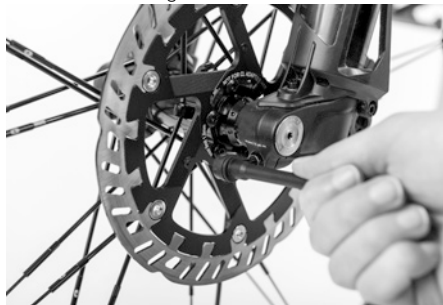
Abb. 52: Verstauen des Pannenzwerkzeugs
