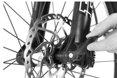
Abb. 53: Montage Vorderradachssystem Cross
