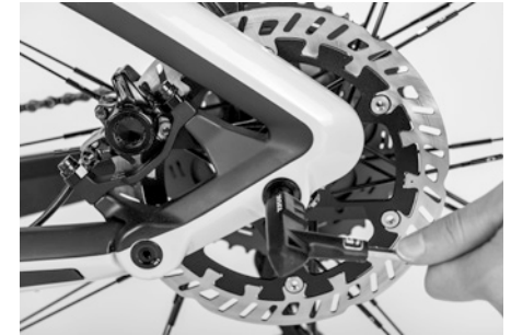
Abb. 54: Montage Achssystem Hinterrad
