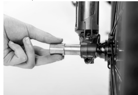
Abb. 49: Montage Vorderradachssystem Sport
