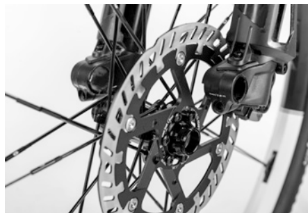
Abb. 48: Montage der Achsverschraubung / Vorderrad
