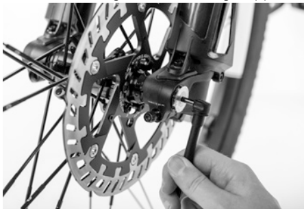
Abb. 50: Montage der Sicherungskappe
