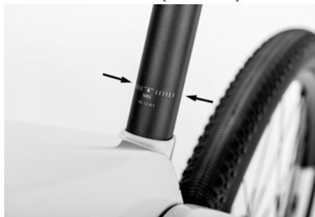
Abb. 39: Sattelstütze (max. Pos.)
