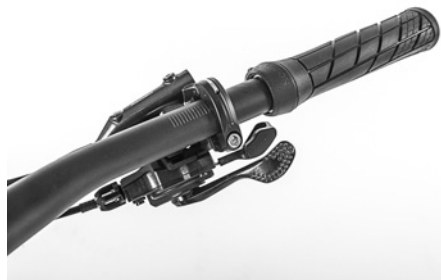
Abb. 23: Position der Schalthebel (mechanisch)
