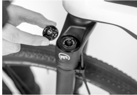
Abb. 43: Druckventil für Gabeldruckeinstellung
