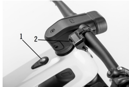
Abb. 5: Ein/Aus Taste (1) und Display Taste (2)
