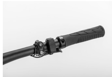
Abb. 24: Position der Schalthebel (elektronisch)
