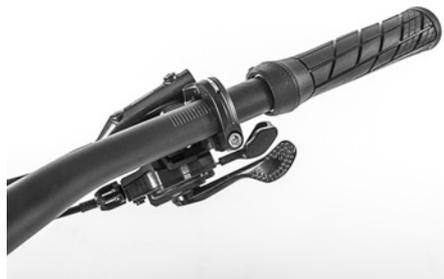
Fig. 24: Posizione della leva del cambio (elettronico)
