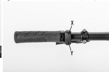
A un livello di supporto più elevato, la trazione elettrica fornisce una coppia più elevata. Nel livello di supporto più basso non viene erogata alcuna coppia aggiuntiva e l'EPAC viene azionato dalla pura forza muscolare.
