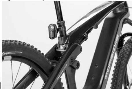
Entrambe le luci sono fornite con le viti corrispondenti. Esse sono serrate con una coppia di 4 Nm.
