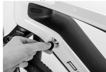
La batteria di trazione si sgancia dall'apposita chiusura nel tubo inferiore. Una piastra di chiusura in due pezzi mantiene la batteria di trazione in posizione e ne impedisce la caduta. Premere la piastra di chiusura in due pezzi e rimuovere la batteria di trazione dall'eBike.
