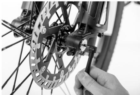
Fig. 51: Montaggio delle viti di bloccaggio
