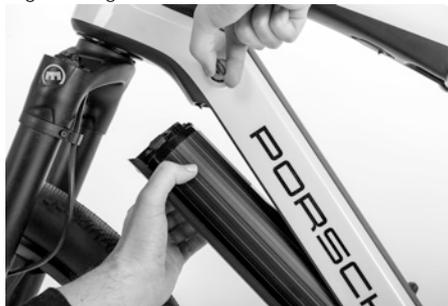
Fig. 31: Rimozione della batteria di trazione
