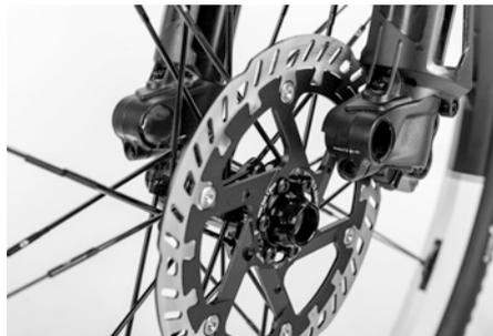
Nelle ruote anteriori della PORSCHE eBike sono montati assi avvitati. Durante l'inserimento del mozzo della ruota anteriore, verificare che il mozzo sia bloccato nel portamozzo e che il disco del freno sia centrato correttamente nella pinza del freno.
