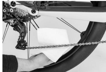
Fig. 21: Lubrificazione della catena
