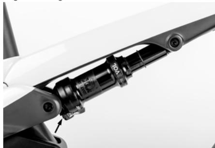
Per una regolazione corretta, nel primo passaggio la manopola di regolazione rossa viene ruotata in senso antiorario fino all'arresto. Quindi, la vite di regolazione viene ruotata a piccoli passi / clic in senso orario finché la corretta regolazione dell'ammortizzatore è impostata.
