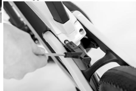
Fig. 11: Controllo del collegamento a cuneo del reggisella
