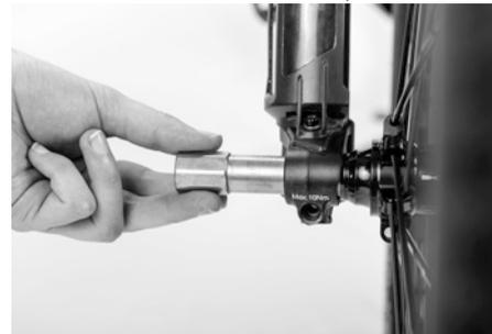
La ruota anteriore della PORSCHE eBike Sport non possiede un collegamento a vite dell'asse senza attrezzi. È necessaria una chiave Torx (misura T25). Prima del montaggio, controllare che la filettatura sia priva di sporco e danneggiamenti. Spingere l'asse a innesto leggermente ingrassato da destra attraverso il portamozzo e il mozzo fino all'arresto.
