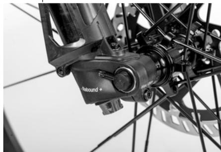
La ruota anteriore della PORSCHE eBike Cross possiede un collegamento a vite dell'asse senza attrezzi. Aprire lo sgancio rapido sull'asse avvitato e spingere l'asse leggermente ingrassato attraverso il mozzo finché il filetto ingrana nel portamozzo contrapposto. Serrare l'asse e applicare il pre-serraggio ribaltando la leva di bloccaggio di 90° verso l'alto.
