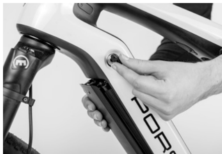
Fig. 33: Blocage de la batterie de transmission
