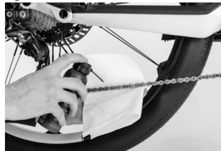
Fig. 21: Graisser la chaîne
