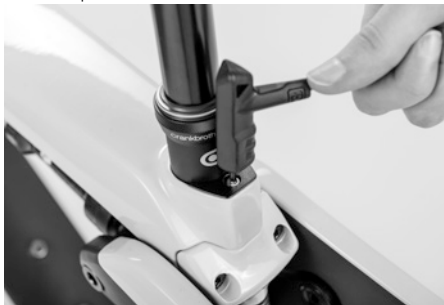
Fig. 42: Vissage à cale / tige de selle Drop- per
