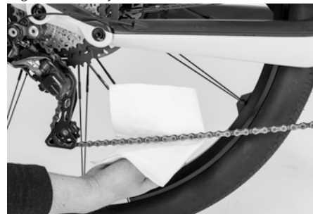
Fig. 21: Graisser la chaîne
