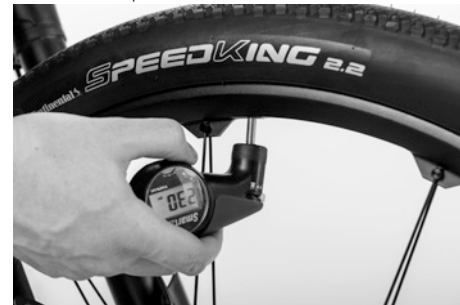
Fig. 12: Contrôler la pression de gonflage des pneus
