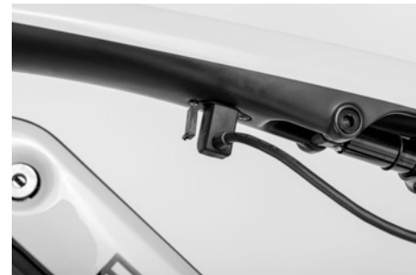
Fig. 7: Câble de chargement fiche / batterie de transmission
