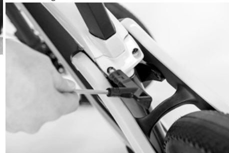
Fig. 10: Contrôler les vis de serrage de la tige de selle)
