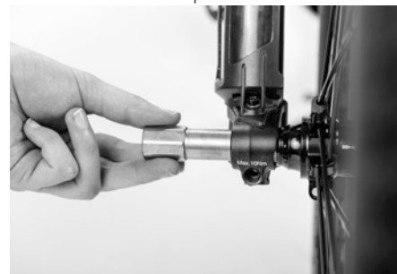
Fig. 49: Montage du système d'essieu de roue avant Sport
