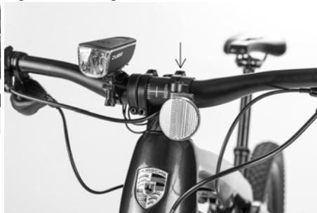
Fig. 62: Montage du réflecteur avant
