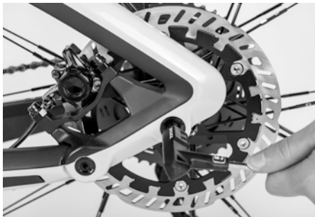
Fig. 54: Montage système d'essieu de roue arrière
