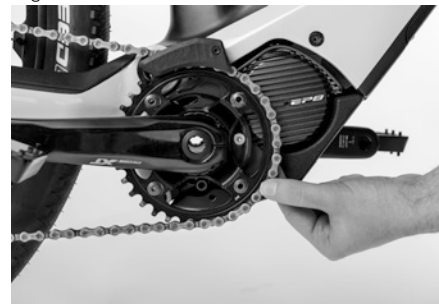
Fig. 22: Contrôler l'état de la chaîne
