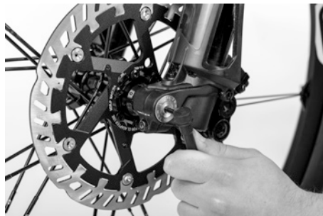
Fig. 8: Contrôler le capuchon de sécurité de la roue avant
