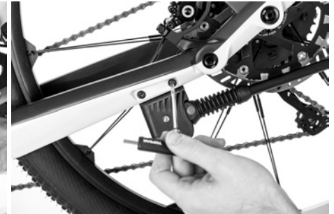
Fig. 57: Montage de la béquille
