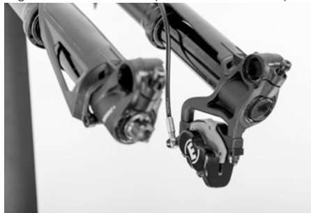
Fig. 64: Cale de transport du frein à disques
