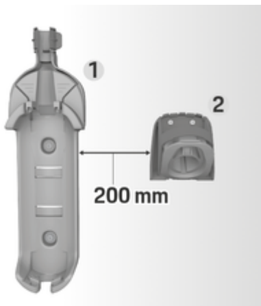
Fig. 2: Distância entre o suporte de parede e o fixador do conector
