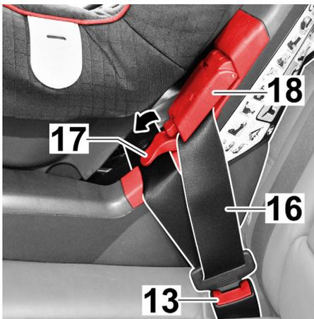
8. Schwenken Sie den Klemmhebel (17) der dunkelroten Gurtklemme (18) auf der Seite des Fahrzeug-Gurtschlusses (13) nach unten.
