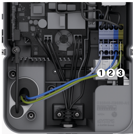
Fig. 34: Borne de conexión (monofásicos)
