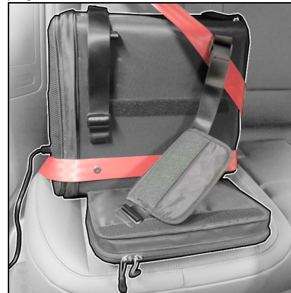
Joonis 5: Turvavöö asend
