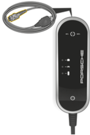
Afb. 7: De stekker van de netkabelverbinding aan de bedieningseenheid
