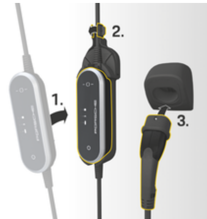
Obr. 6: Zavěšení ovládací jednotky
